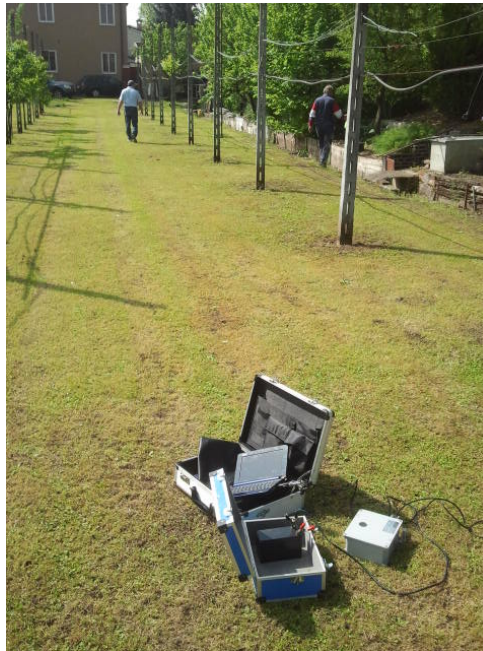
HVSR1 : Sismografo triassiale in dotazione con sensori ortogonali da 4,5 Hz e convertitore A/D 24 bit
